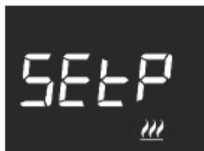
**Impostazione setpoint di funzionamento (se controllo "setpoint")**
