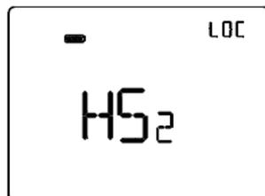
**HS2 (Velocità 2 fan coil riscaldamento)**
