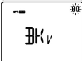
Se il tipo di gestione è SENS, utilizzare i tasti o per incrementare (+10%), decrementare (-10%) o lasciare invariato (0%) il valore di luminosità rilevato dal sensore crepuscolare a bordo. Per confermare la scelta e passare al parametro successivo, premere il tasto entro 30 secondi.
