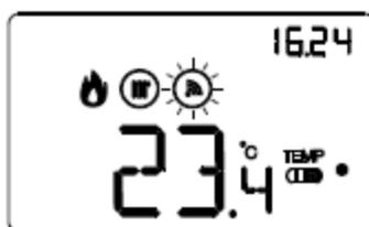
L'abilitazione dei comandi remoti permette di impostare da remoto il tipo e la modalità di funzionamento del termostato, ad esempio tramite il remotizzatore GSM Easy. Durante il normale funzionamento del termostato, alla ricezione di un comando da remoto, il simbolo lampeggia finché la modalità attiva rimane quella impostata da remoto.
