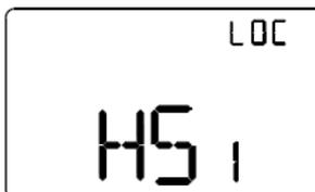
**HS1 (Velocità 1 fan coil riscaldamento)**
