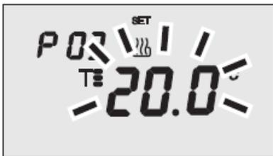
**P03<sub>risc</sub> - Impostazione Set Point T<sub>☺</sub> (riscaldamento)**
