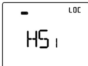
**HS1 (Velocità 1 fan coil riscaldamento)**
