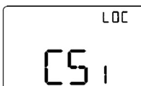
**CS1 (Velocità 1 fan coil raffrescamento)**
