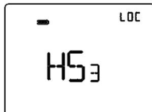
**HS3 (Velocità 3 fan coil riscaldamento)**
