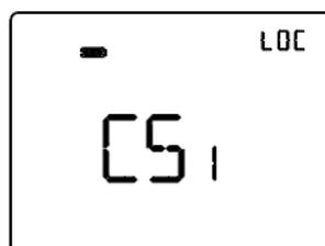
**CS1 (Velocità 1 fan coil raffreddamento)**
