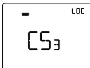
**CS3 (Velocità 3 fan coil raffreddamento)**
