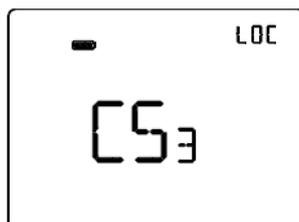
**CS3 (Velocità 3 fan coil raffreddamento)**
