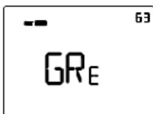
Utilizzare i tasti o per impostare il peso della componente verde (GRE) nella retroilluminazione del display (valore impostabile da 1 a 63). La regolazione è valida solo per il colore bianco dello schermo.
