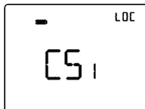
**CS1 (Velocità 1 fan coil raffreddamento)**
