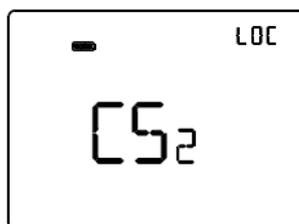
**CS2 (Velocità 2 fan coil raffreddamento)**
