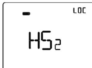
**HS2 (Velocità 2 fan coil riscaldamento)**
