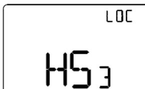
**HS3 (Velocità 3 fan coil riscaldamento)**
