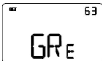
Utilizzare i tasti o per impostare il peso della componente verde (GRE) nella retroilluminazione del display (valore impostabile da 1 a 63). La regolazione è valida solo per il colore bianco dello schermo.
