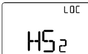
**HS2 (Velocità 2 fan coil riscaldamento)**
