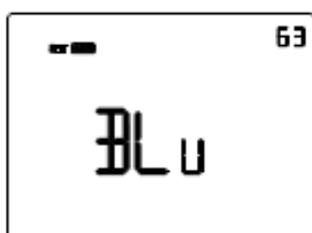
Utilizzare i tasti o per impostare il peso della componente blu (BLU) nella retroilluminazione del display (valore impostabile da 1 a 63). La regolazione è valida solo per il colore bianco dello schermo.
