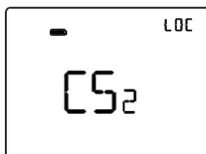
**CS2 (Velocità 2 fan coil raffreddamento)**
