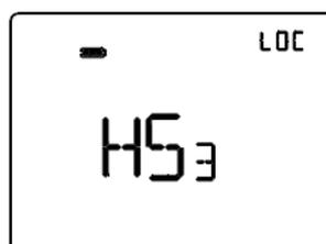
**HS3 (Velocità 3 fan coil riscaldamento)**
