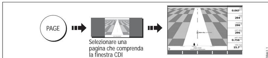
Quando l'applicazione CDI è visualizzata i tasti soft non vengono usati. Per accedere a qualunque funzione attivata tramite i tasti soft dovete quindi aprire una finestra radar, chartplotter o fishfinder.
