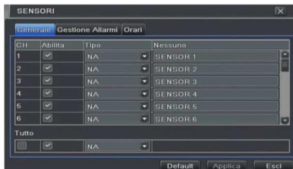
Ad esempio: selezionare il tipo di allarme e il nome del sensore/ingresso. E' possibile impostare le telecamere da registrare (anche più di una per ogni ingresso d'allarme) , il tempo, l'eventuale attivazione dell'uscita e l'invio di e-mail.
