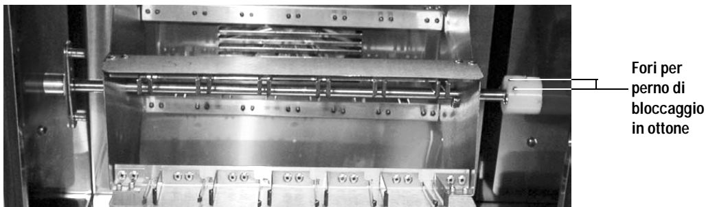
Figura 5 Montaggio corretto del rotatore
