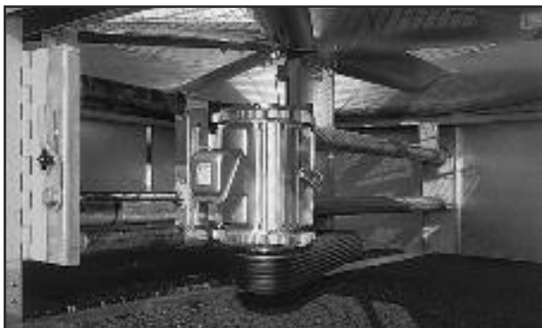
Motore assemblato alla base
