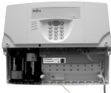
Vite di bloccaggio
