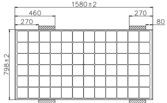
Nota: spazio di fissaggio massimo di 1.040mm.
