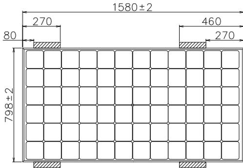
Nota: spazio di fissaggio massimo di 1.040mm.
