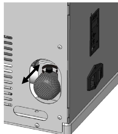
Montaggio/smontaggio del filtro dell'aria
