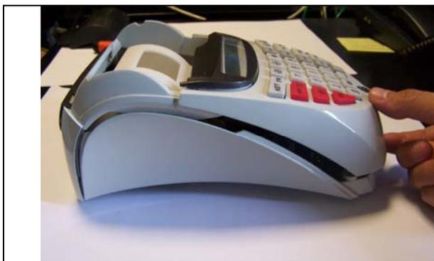
Figura D3.13: Assemblare il cabinet superiore
