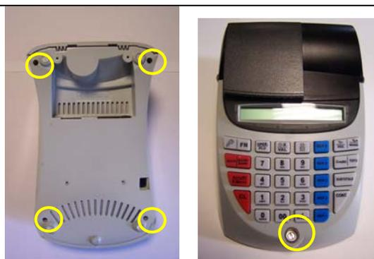
Figura D3.14: Assemblare le 4 viti posteriori e la vite fiscale
