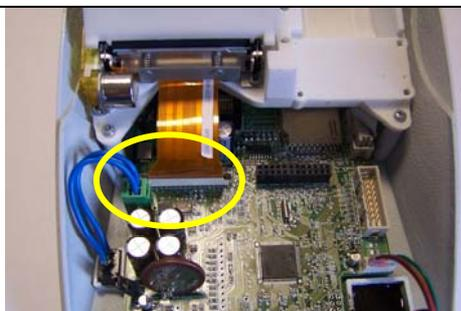
Figura D3.12: Connettere il flat della stampante ed il cavo dell'interruttore ON/OFF
