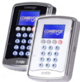
Tastiera dall'esclusivo design in policarbonato lucido **per tutte le centrali Combivox**. Display LCD grafico. 4 tasti menù multifunzione per inserimento/disinserimento, esclusione zone, gong, scenari, etc.; microfono e altoparlante per guida utente a sintesi vocale. 1 zona di allarme (NC, NA, SING. BIL.). Lettore di prossimità e sonda di temperatura integrati. Interfaccia utente ad icone. Funzione di campanello vocale delle zone. Dimensioni (L x H x P in mm): 100 x 160 x 23.
