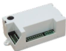
Attuatori domotici radio 868 MHz a 220 V in contenitore per cassetta 504 per la gestione di carichi fino ad un'assorbimento di 5 A e tensione 220 V. Versione per tapparelle: 2 uscite a relè + 6 ingressi (apertura locale, chiusura locale, blocco, sicurezza, apertura e chiusura centralizzata). Versione per controllo luci: 2 uscite a relè + 6 ingressi (2 impulsivi, 2 a stato, 2 per comando passo-passo). Compatibili con centrali Amica 2012. Dimensioni (L x H x P in mm): 57 x 101 x 40.
