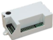
In contenitore per 504 per la gestione di carichi fino ad un'assorbimento di 5 A e tensione 220 V. Versione per tapparelle: 2 uscite a relè + 6 ingressi (apertura locale, chiusura locale, blocco, sicurezza, apertura e chiusura centralizzata). Versione per controllo luci: 2 uscite a relè + 6 ingressi (2 impulsivi, 2 a stato, 2 per comando passo-passo). Dimensioni (L x H x P in mm): 57 x 101 x 40.
