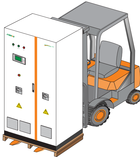
Fig 6-14 Utilizzo di un carrello elevatore a forche per movimentare il dispositivo SG100K3 con il pallet di legno
