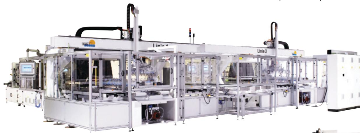
Il Rapid Two della Somont è un sistema ad alta velocità per la brasatura delle celle, che produce 1.200 celle all'ora.
