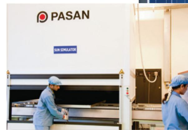
Il simulatore di luce solare-flash della PASAN della classe di rendimento A per la misurazione del rendimento in condizioni di test standard presso la EMMVEE in Bangalore, India
