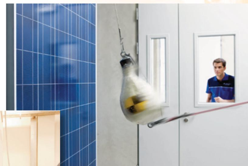
I test di frattura modulo per i moduli fotovoltaici nel laboratorio presso il TÜV Rheinland a Colonia (fonte: TÜV Rheinland)
