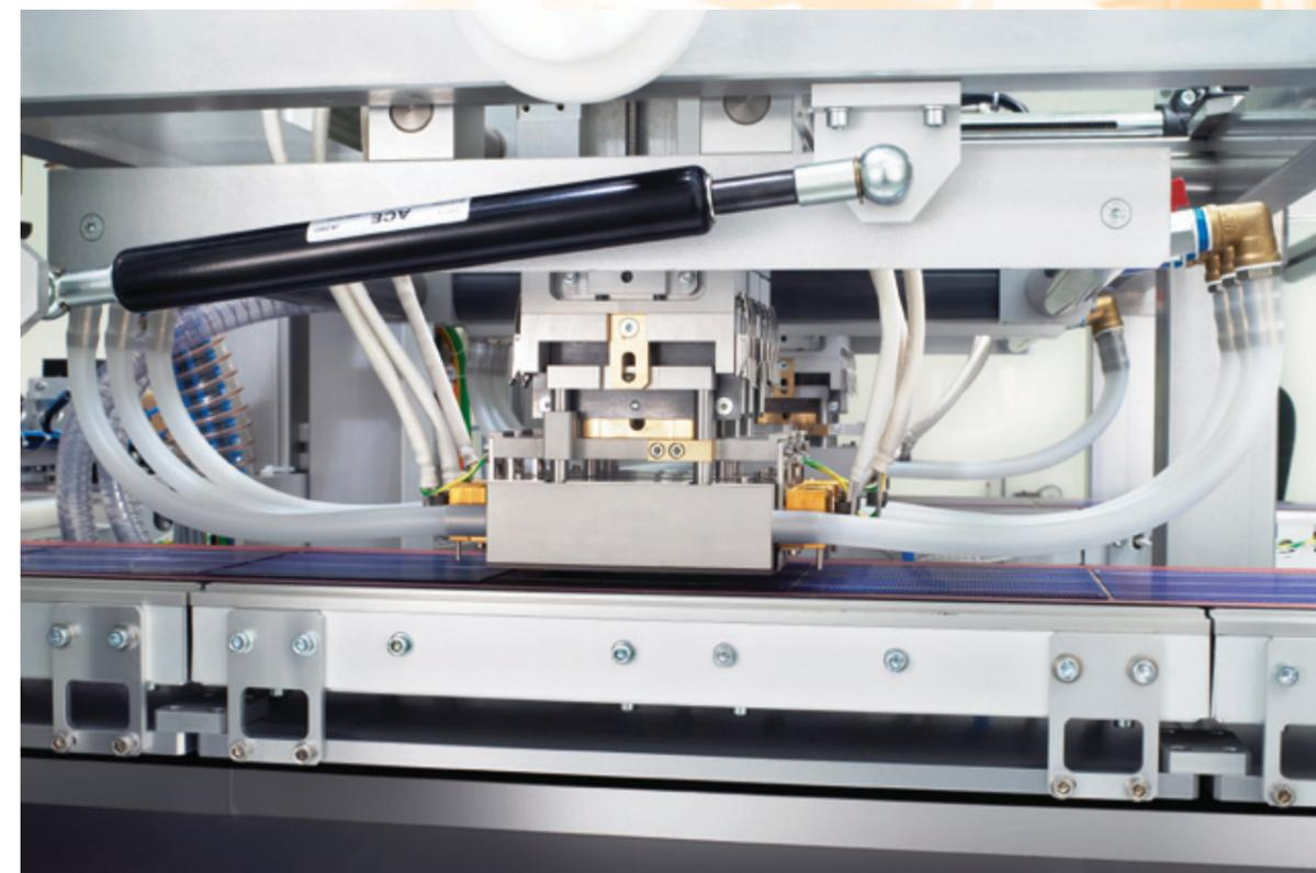
Le celle solari vengono saldate automaticamente. In questo modo, c'è un basso carico di temperatura e un relativo impatto termale basso per le celle sensibili.
