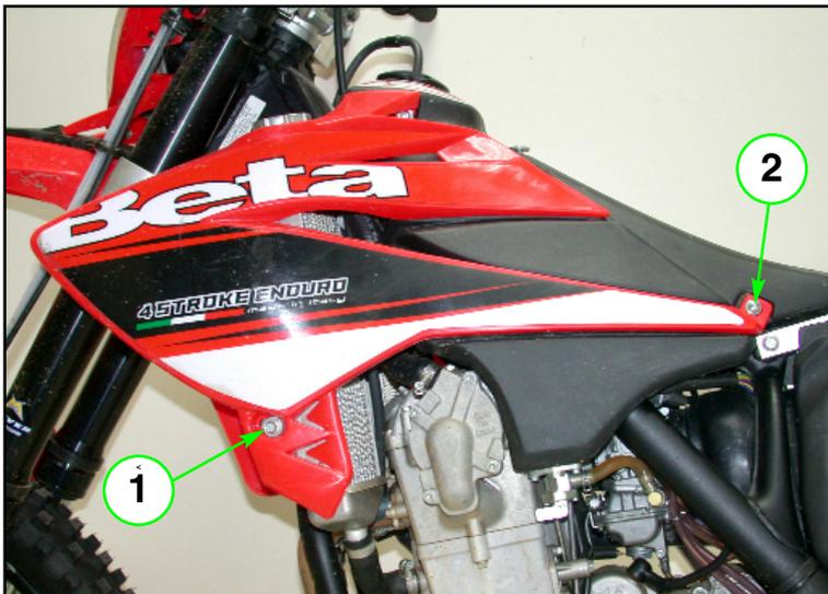
**ATTENZIONE** Smontare con particolare cura i bulloni delle fianchette in posizione 1 fissati sul radiatore.
