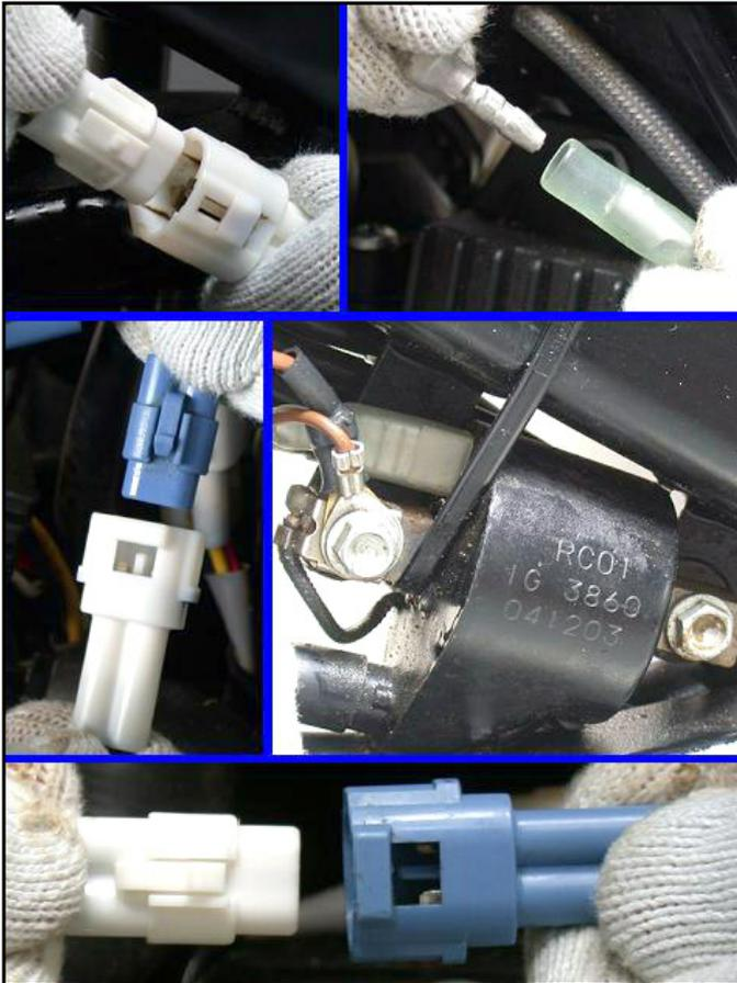
**NOTA:** laddove i connettori del cablaggio FAST non coincidessero con i colori del cablaggio originale, riferirsi alle indicazioni colorate utilizzate per identificare le corrispondenze di connessione (ad esempio: pallino di vernice colorata)
