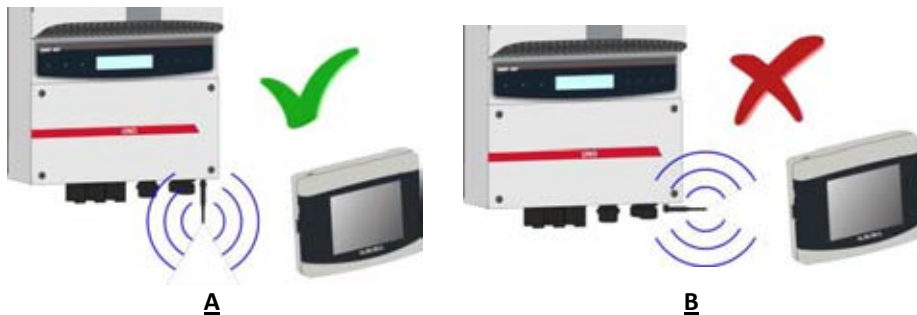
Figura 8 - Posizione reciproca di antenna e PVI-DESKTOP a. ricezione ottimale b. ricezione debole
