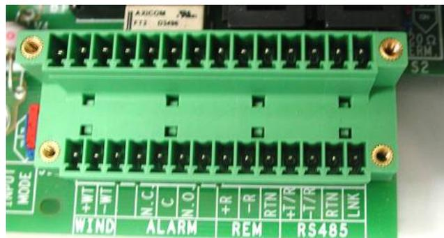
Fig. 22 morsettiera dei contatti di allarme
