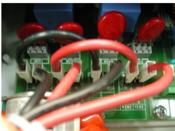
Connessione parallelo dei due canali
