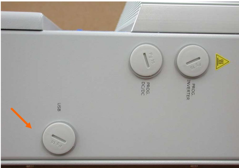
Fig.26 Collegamento USB
