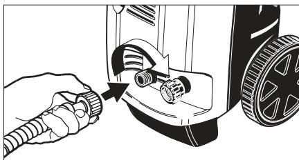
→ **ETAPE 4 :** Raccorder le tuyau d'arrosage à la source d'eau froide et ouvrir complètement le robinet. Brancher le cordon d'alimentation dans la prise.
