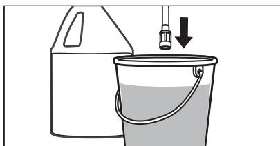
→ **ETAPE 3 :** Mettre le nettoyeur à haute pression en marche (I). Appuyer sur la gâchette pour faire fonctionner l'appareil : le détergent liquide est aspiré dans l'appareil et mélangé à l'eau. Appliquer le détergent sur la surface à nettoyer. Ne pas laisser sécher.
