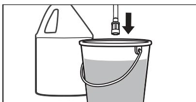
→ **PASO 3:** Encienda el limpiador de alta presión (I). Presione el gatillo para poner en funcionamiento la unidad: El detergente líquido es introducido en la unidad y mezclado con agua. Aplique detergente al área de trabajo. No deje que se seque el detergente sobre la superficie.
