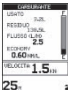
Se l'opzione CARBURANTE non compare nella schermata del MENU PRINC., abilitarla tramite l'opzione IMPOSTAZIONI - INSTALLAZIONE (vedi sezione 4-8).
