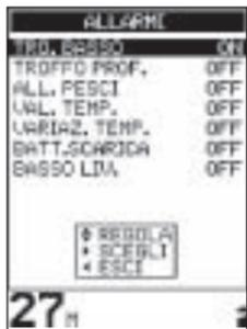
Gli allarmi possono essere abilitati per rilevare automaticamente determinate condizioni, come ad esempio la presenza di un fondale eccessivamente basso. Le impostazioni di soglia degli allarmi possono essere regolate in funzione delle caratteristiche dell'imbarcazione e delle proprie preferenze.
