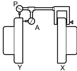
2. Ruotare la metà del giunto della pompa (X) per verificare che i comparatori siano a contatto con la metà del giunto del trascinatore (Y), ma non sporgano.
