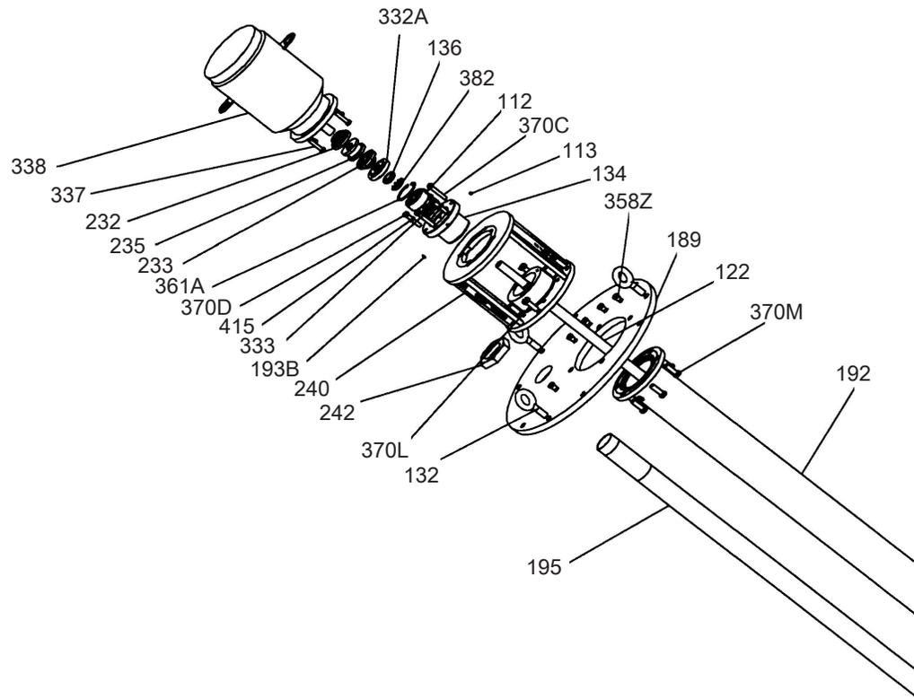
Figura 6: Vista esplosa 3171 (parte 1 di 2)
