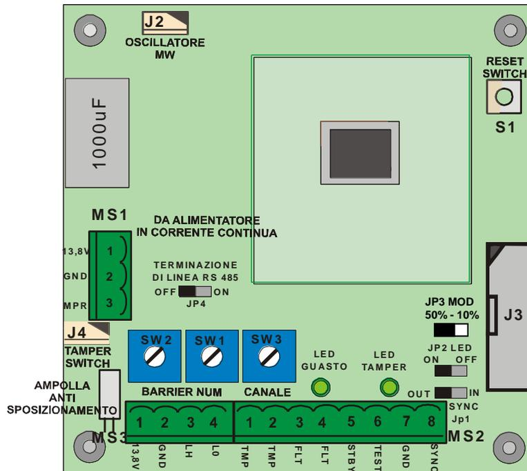
Figura 8 Disposizione topografica dei componenti nel circuito Tx
