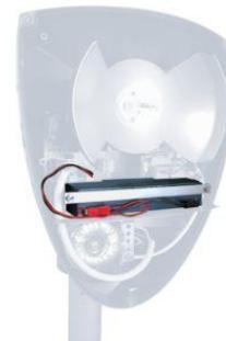
3. Collegare i "fastons" alla batteria rispettando le polarità, cioè filo rosso, (Morsetto 1 di MS2) al positivo di batteria, filo nero (Morsetto 2 di MS2) al negativo di batteria.
