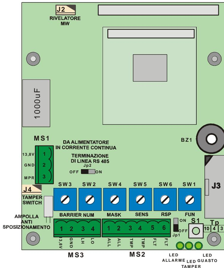
Figura 9 Disposizione topografica dei componenti nel circuito Rx
