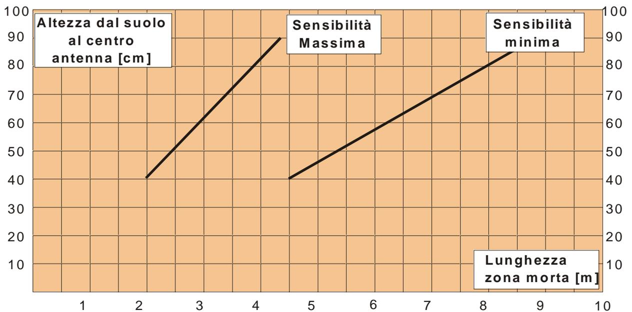
Figura 6 Lunghezza della zona morta in prossimità degli apparati in funzione dell'altezza dal centro dell'antenna al suolo per CORAL- PLUS 220
