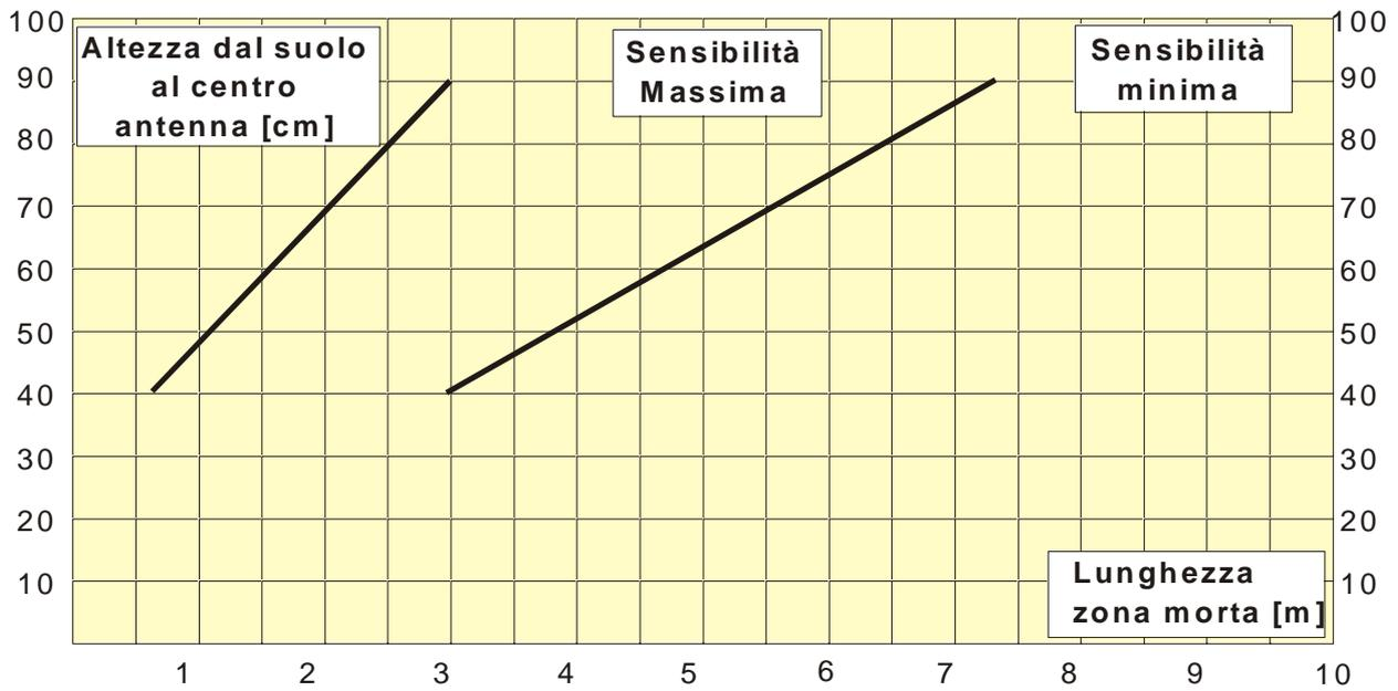
Figura 5 Lunghezza della zona morta in prossimità degli apparati in funzione dell'altezza dal centro dell'antenna al suolo per CORAL PLUS 100
