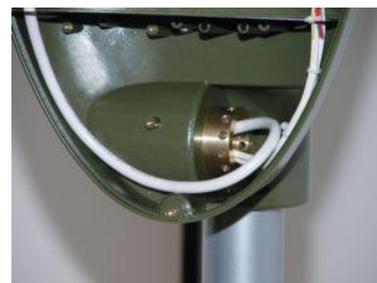
6. Alla fine delle operazioni, richiudere la testa a MW, accostando il radome al fondo, quindi avvitare le 6 viti.
