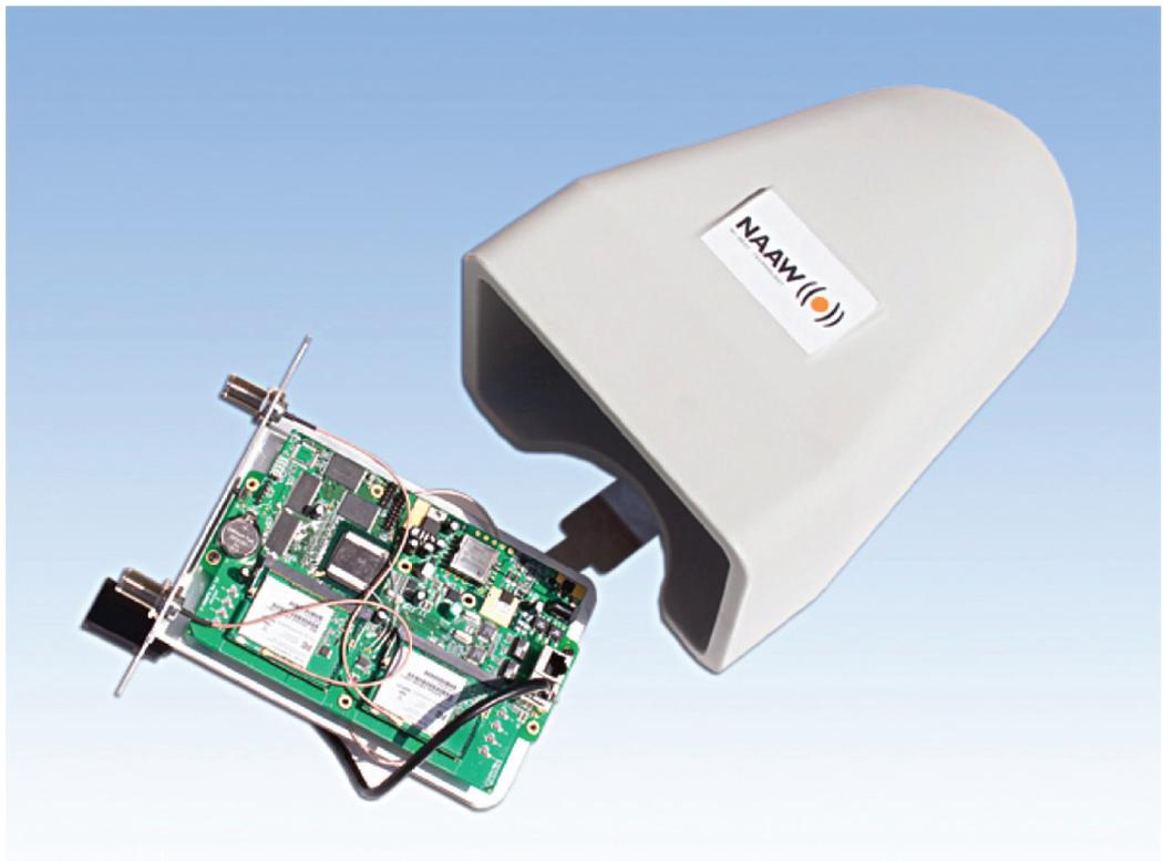
L'unità "ODU" è alimentata a 48V/30W, garantendo la sicurezza dell'installatore.
