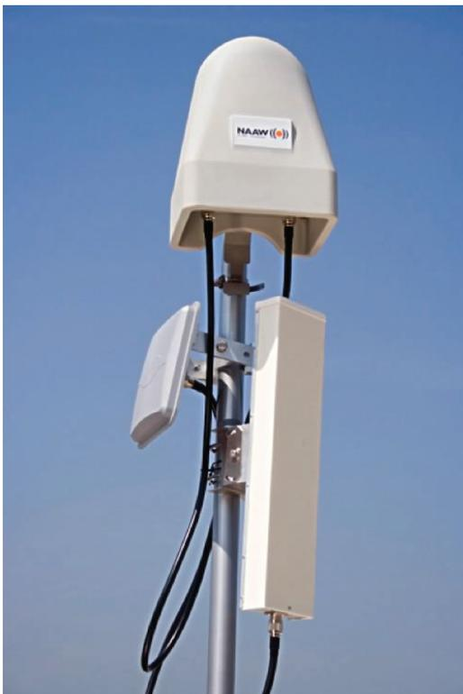
*Fig. 2 Unità radio ODU*
