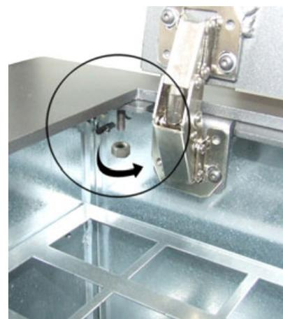
9) Aprire lo sportellino di carico pellet e bloccare il coperchio ai montanti posteriori con i bulloni forniti.
