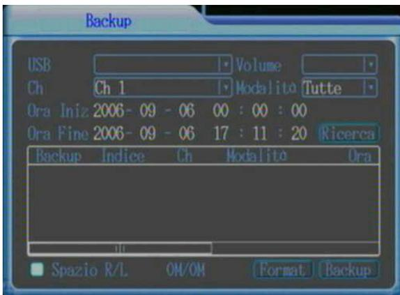
Inserire la periferica USB (masterizzatore o pen drive), entrare nel menù Backup e controllare che sia stata riconosciuta dalla macchina: comparirà il tipo di periferica con la relativa capacità disponibile.
