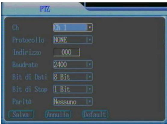
Configurare i parametri di comando di speed-dome eventualmente collegate al dvr.
