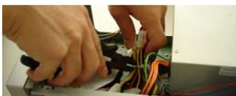
6. Fissare il Supporto al case avvitando le quattro viti.
