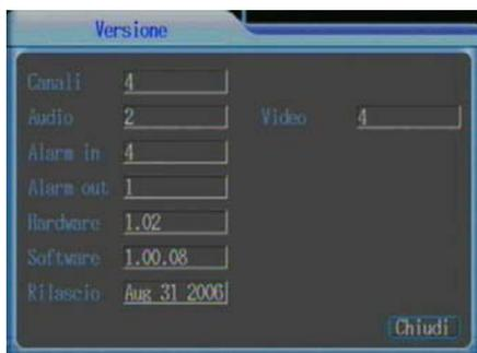
Visualizza la versione della macchina: il numero di ingressi video, il numero di ingressi audio, il numero di ingressi di allarme, le uscite di allarme, la versione hardware e software con la relativa data di rilascio.
