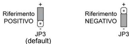
Figura 36 - Configurazione hardware delle uscite elettriche
