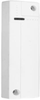
Rivelatore a contatto magnetico per rivelare lo stato di apertura o chiusura della porta o della finestra su cui è installato. Dispone di un ingresso ausiliario programmabile, a cui è possibile collegare altri rivelatori NC (normalmente chiusi) o un rivelatore per tapparella. È alimentato con batteria al litio e comunica via radio con il modulo radio ER500 in modalità bidirezionale.
