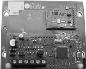
Modulo radio opzionale che permette di integrare nella centrale filare MP500/4, MP500/8 e MP500/16 dispositivi radio quali rivelatori ad infrarosso, contatti magnetici, sirene e telecomandi.
