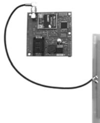
Interfaccia che permette la connessione delle centrali MP500/8 e MP500/16 alla rete telefonica cellulare (GSM) per l'invio di notifiche di allarme e la ricezione di comandi da remoto.
