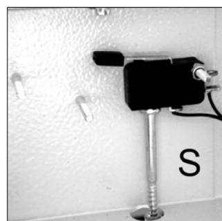
Figura 28 - Montaggio tamper centrale MP500/16
