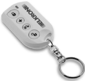
Il telecomando è alimentato con una batteria al litio e comunica via radio con l'espansione ER500 in modalità bidirezionale.
