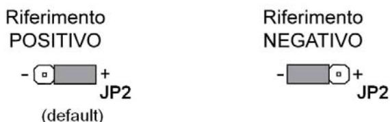
Figura 32 - Configurazione hardware delle uscite elettriche
