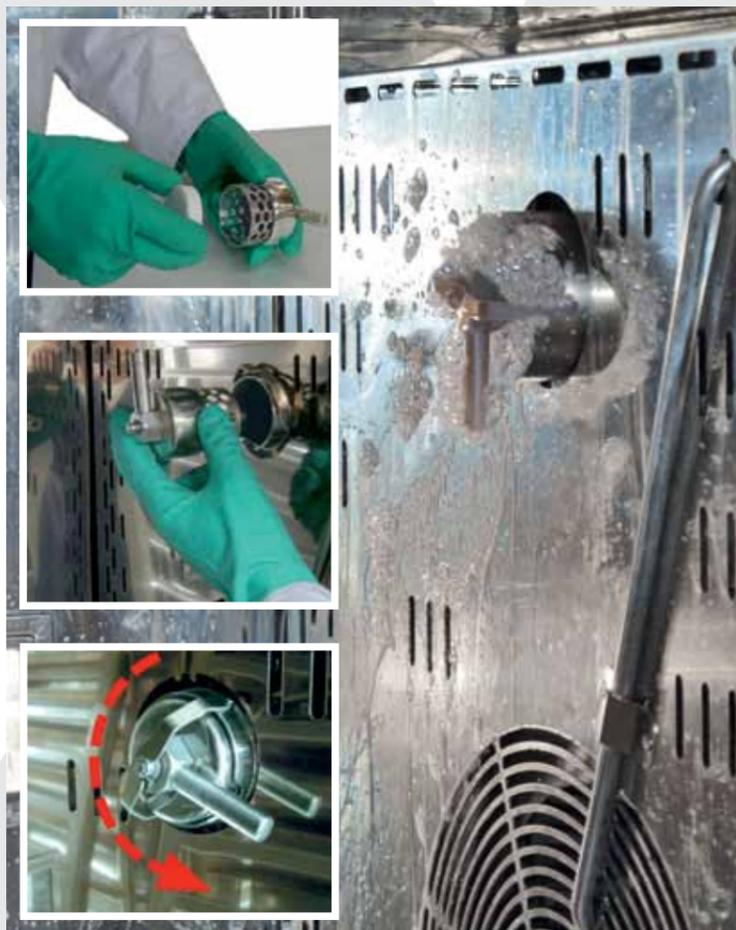
XT COMPACT e XT TOP a pavimento, oltre ai 2 dispositivi di lavaggio XT MULTI CLEANER®, installati nella parte superiore del convogliatore, hanno un dispositivo di risciacquo posizionato nella parte centrale (della parete di fondo della camera di cottura); la sua funzione è di aumentare l'efficacia del risciacquo al termine del lavaggio.
