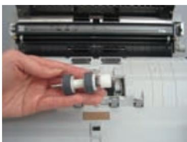
I rulli sono facili da sostituire.
