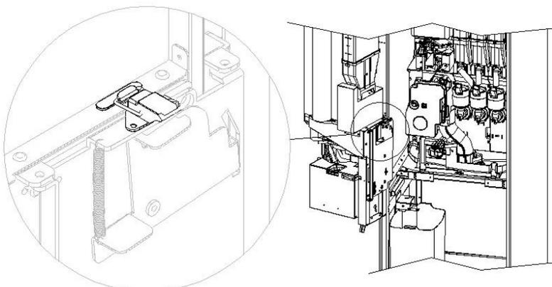
Per avere ancor più accessibilità al componente, sganciare la chiusura a leva indicata nella figura, si sbloccherà così il secondo snodo.
