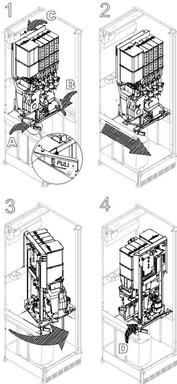
Le figure in sezione a lato, riportano in sequenza le operazioni da eseguire, per accedere agli elementi disposti sul retro dove normalmente è necessario rimuovere gli elementi disposti davanti ad essi.
