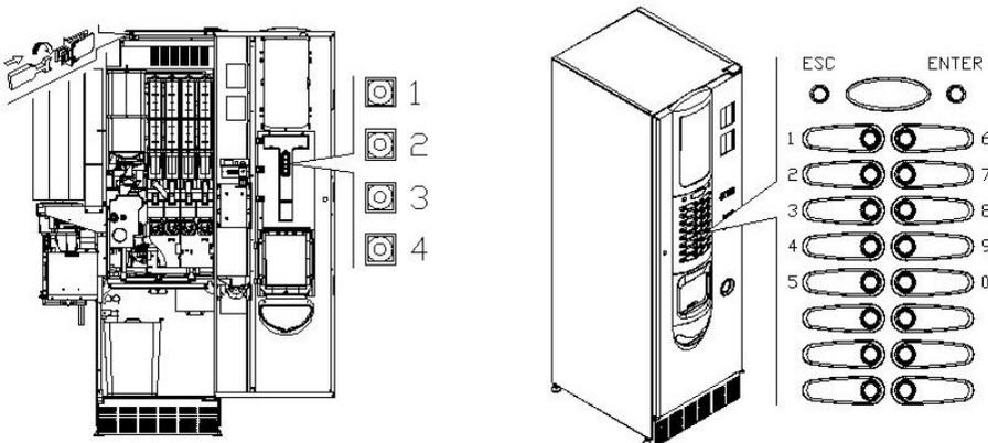
**Pulsante programmazione:** entrando in programmazione, il display visualizza **Comando 00**. Da questo menù principale, si può accedere direttamente ad alcuni dati oppure ad altri sottomenù. Digitare sulla **Pulsantiera a selezione diretta**, il corrispondente comando e premere **il tasto ENTER**, per confermare la scelta.
