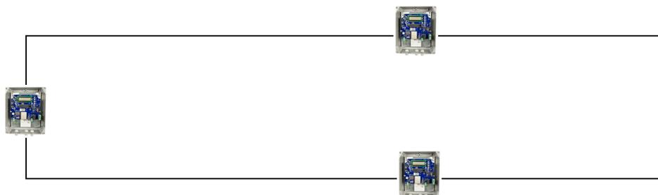
Distanza fra un analizzatore e l'altro: cavo max. 100m
