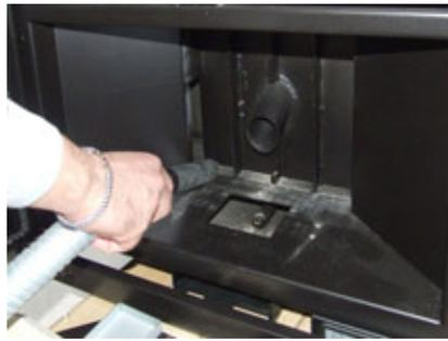
4) Con l'aiuto di un aspiratore pulire il vano scambiatore posto dietro al pannello posteriore in vermiculite e pulire tutta la camera di combustione.
