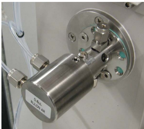
Figura 4-2 Valvola di iniezione liquido Siemens (installata)
