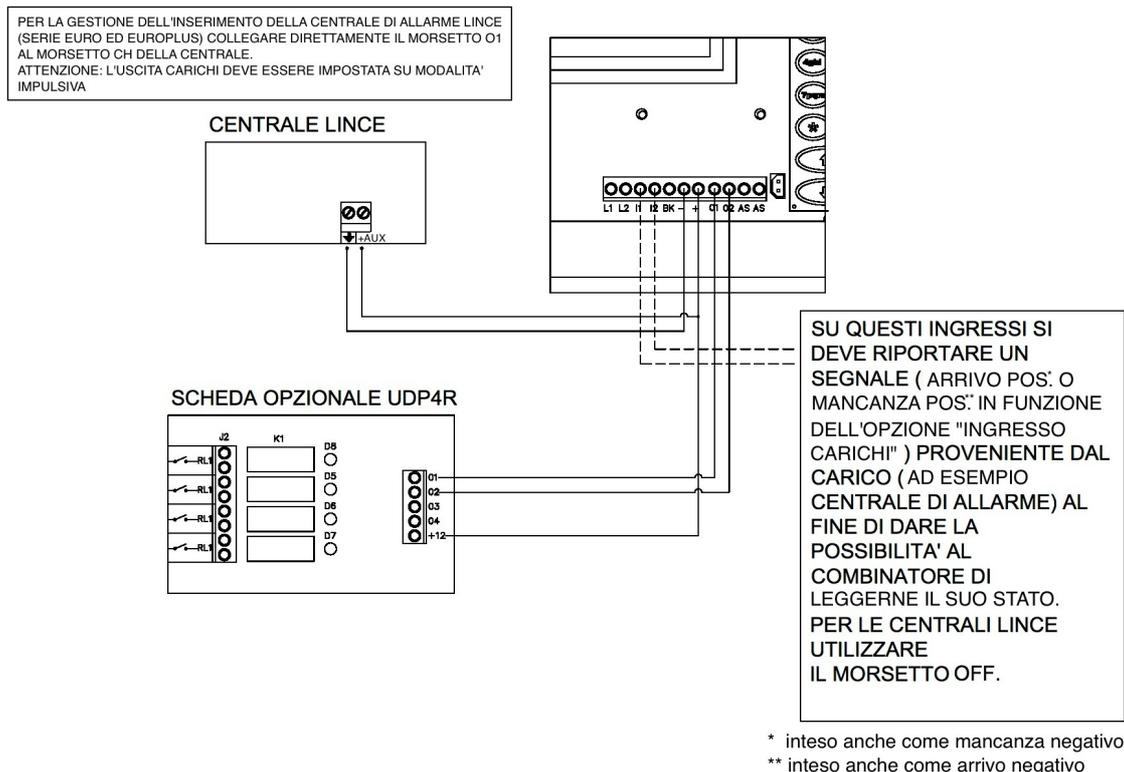
Illustrazione 7: esempio di collegamento carichi tramite scheda di interfaccia LINCE
