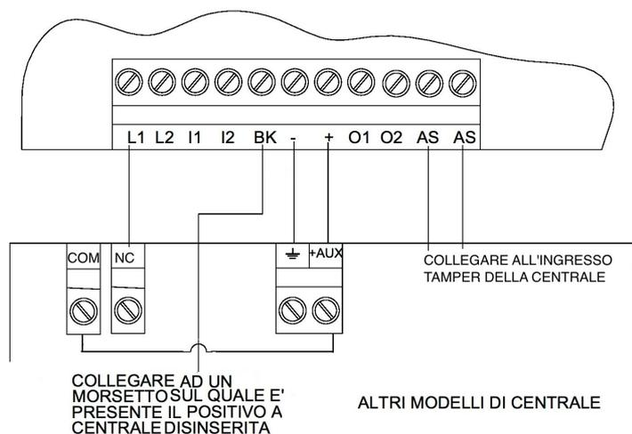
Illustrazione 6: esempio di collegamento base con altri modelli di centrale
