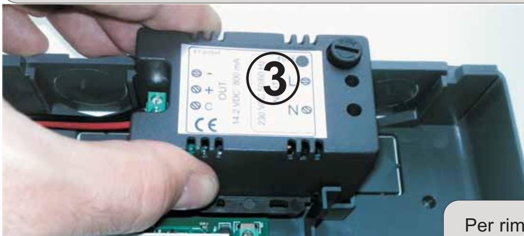
Per rimuovere il circuito **tirare verso l'alto dal lato destro**. Il circuito è ancorato tramite 4 supporti ad innesto rapido
