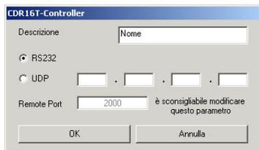
Compilare il campo *Descrizione* con una sigla identificatrice del CDR-16T in questione e quindi definire il tipo di supporto utilizzato. Selezionare il campo *RS232* in caso si necessiti di collegarsi con un dispositivo direttamente collegato al PC attraverso una delle porte seriali o *UDP* in caso si utilizzino gli IPCom. In questo ultimo caso è necessario impostare nelle quattro caselle poste sulla destra della voce *UDP* l'indirizzo IP del webserver IPCom.
