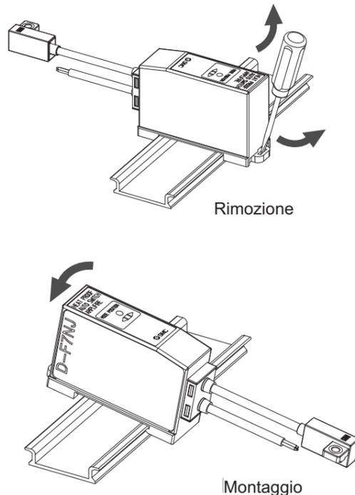
6. Montaggio/supporto di montaggio (Sensore)
