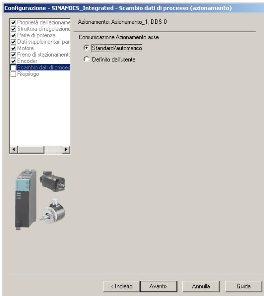
Figura 7-9 Progettazione dello scambio dati di processo (standard)
