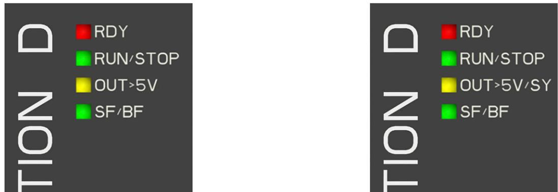
Figura 9-1 Indicatori LED: D410-2 DP (a sinistra in figura), D410-2 DP/PN (a destra in figura)
