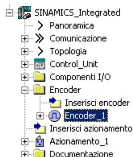
Figura 7-27 Progettazione di un encoder come oggetto di azionamento
