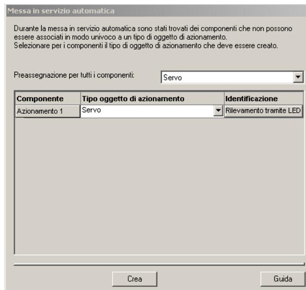
Figura 7-13 Selezione del tipo di oggetto di azionamento
