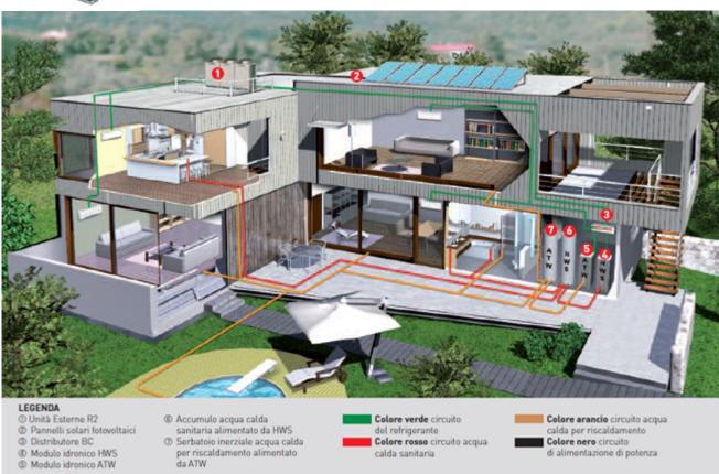
La tecnologia delle pompe di calore Ecodan® si arricchisce con i moduli idronici per la produzione di acqua calda per uso sanitario (HWS) e per il riscaldamento con pannelli radianti (ATW), perfettamente integrabili con l'inserimento di pannelli solari sia termici che fotovoltaici nell'impianto. Gli impianti con i sistemi a pompa di calore elettrica possono funzionare durante tutto l'arco dell'anno, in quanto slegati da ogni vincolo legislativo.
