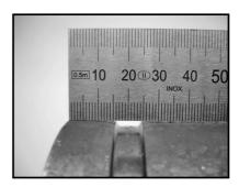
Misurare la lunghezza della sede guarnizione A e la larghezza della scanalatura B utilizzando un righello, un metro a listelli o a nastro con scala lineare per garantire che le dimensioni rientrino entro i limiti di tolleranza specificati nella colonna 3 e colonna 4 della tabella 1.
