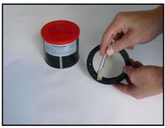
Al fine di evitare possibili schiacciamenti, è necessario lubrificare leggermente la superficie esterna della guarnizione e quella interna dei "mezzi gusci" per i giunti nonché l'interno dei lembi di sigillatura e l'esterno delle estremità del tubo.
