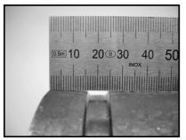
Misurare la lunghezza della sede guarnizione A e la larghezza della scanalatura B utilizzando un righello, un metro a listelli o a nastro con scala lineare per garantire che le dimensioni rientrino entro i limiti di tolleranza specificati nella colonna 3 e colonna 4 della tabella 2.
