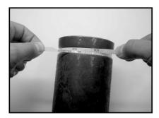
Misurare la zona inferiore della scanalatura utilizzando un nastro diametrico, un nastro a circonferenza o un calibro a corsoio misurando a 0° e a 90° sulla circonferenza in modo da garantire che il diametro della zona inferiore della scanalatura C o la circonferenza della zona inferiore della scanalatura rientri entro i limiti di tolleranza specificati nella colonna 5 di cui alla tabella 1.
