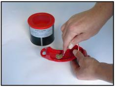
Coprire l'interno dei mezzi gusci del giunto con un sottile strato di lubrificante.
