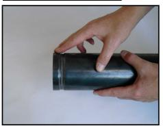
L'estremità del tubo deve essere priva di sbavature al fine di evitare danni alle guarnizioni in fase di assemblaggio.
