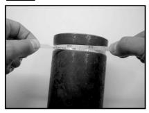
Misurare la zona inferiore della scanalatura utilizzando un nastro diametrico, un nastro a circonferenza o un calibro a corsoio misurando a 0° e a 90° sulla circonferenza in modo da garantire che il diametro della zona inferiore della scanalatura C o la circonferenza della zona inferiore della scanalatura rientri entro i limiti di tolleranza specificati nella colonna 5 di cui alla tabella 2.
