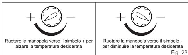
Tenete presente che è possibile regolare la temperatura ambiente tra 10°C e +30°C circa. Se l'apparecchio non è dotato di quadro comando a bordo ma è comandato da termostato a parete, fate riferimento alle istruzioni d'uso del termostato.
