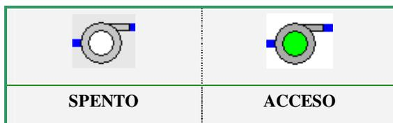
Lo stato di allarme della pompa è dato dallo stato di allarme dell'interruttore magnetotermico corrispondente.
