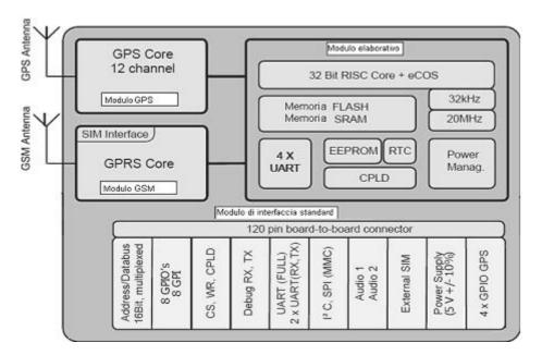
Il sistema contiene un micro-controllore MCU RISC a 32 bit connesso esternamente a due unità di memoria espandibili di tipo SRAM di tipo FLASH, ambedue espandibili, utili alla memorizzazione del software applicativo e al supporto di funzionalità di data logging per il cacheing dei dati raccolti ed in attesa di invio alla centrale operativa.
