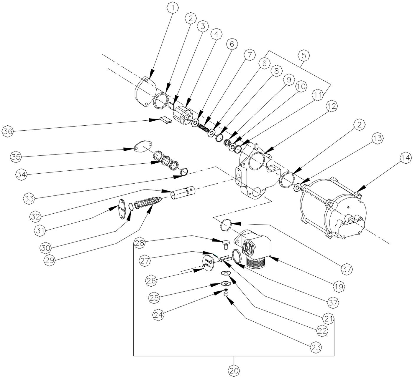
**DIRECT DRIVE MOTOR-PUMP ASSEMBLY**
