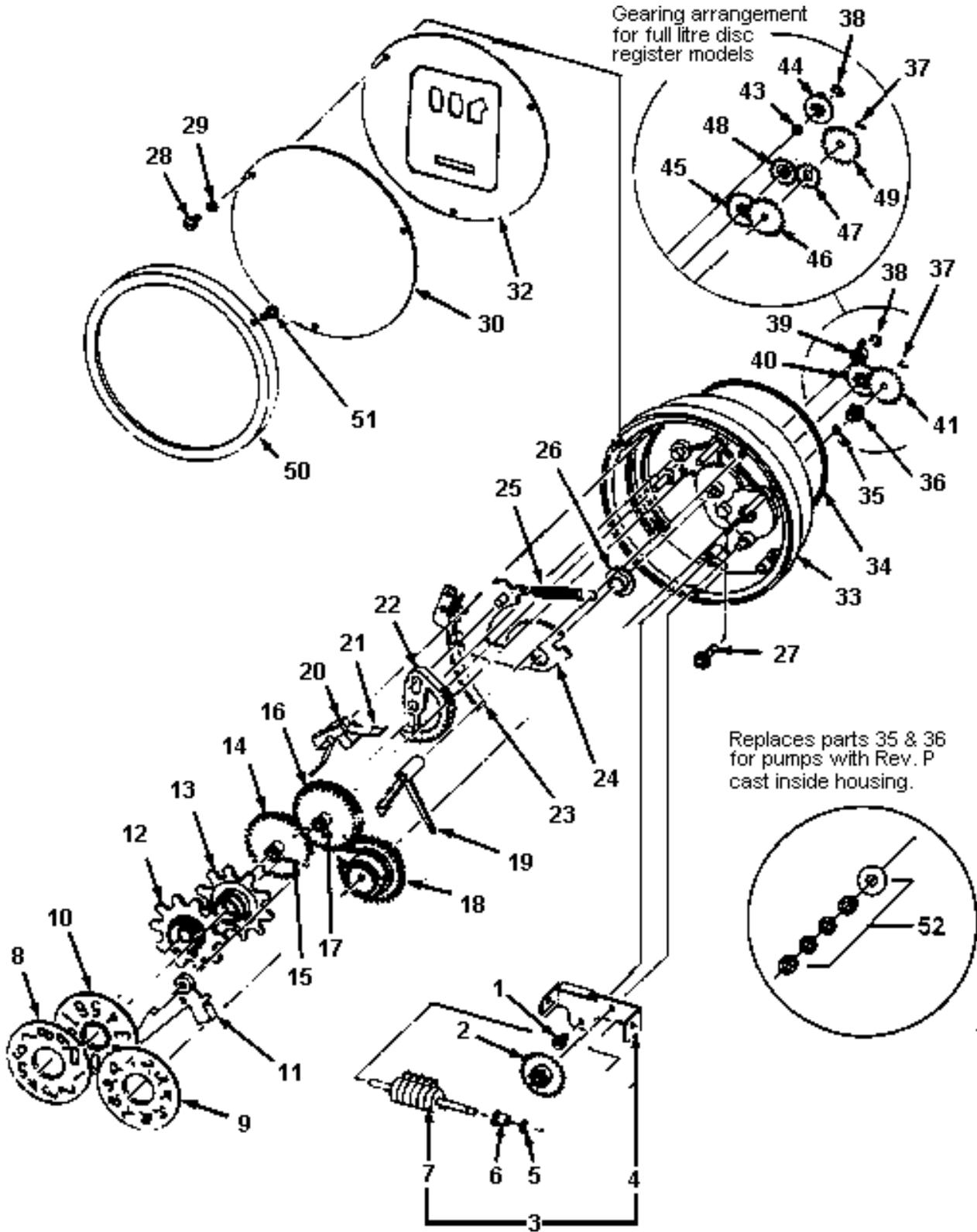
**1860 3-WHEEL METER REGISTER (FOR MODEL 1820)**
