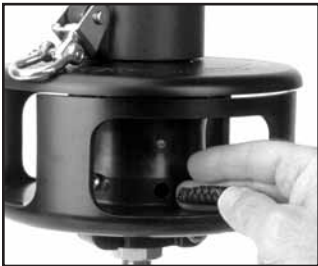
Pass line through enclosed window. Tirer la drosse à travers la fenêtre du guide anti usure. Leine neu durch Fenster fädel. Passare la cima in una delle due aperture della guida.
