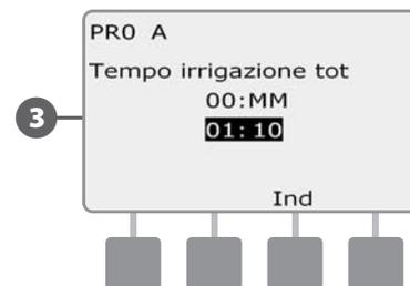
! **NOTA:** Per stazioni impostate per ciclo+pausa, il tempo di ciclo (quando si verifica l'irrigazione) sarà incluso nei calcoli del tempo di esecuzione del programma ma i tempi di pausa NON saranno inclusi. Per ulteriori dettagli vedere Ciclo+pausa nella Sezione D.
