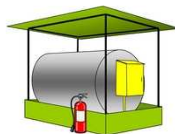
Fig. 11: Serbatoio mobile per carburante
