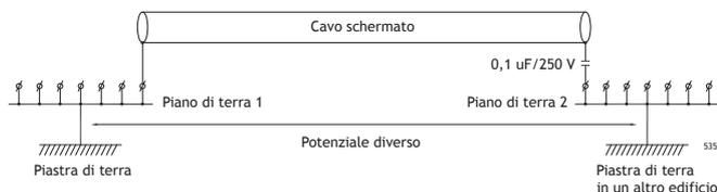
Con distanze maggiori, sussiste il rischio che il potenziale di terra possa essere diverso. In questo caso, lo schermo deve essere collegato solamente ad una estremità. Una buona alternativa è collegare l'altra estremità dello schermo a terra tramite un condensatore plastico da  $0.1 \mu\text{F}/250 \text{ V}$ . In questo modo, entrambe le estremità sono collegate a terra per quanto riguarda HF, ma solamente ad una estremità per quanto riguarda LF, evitando così i loop di terra a 50 Hz.
