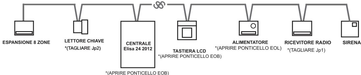
**\*COLLEGAMENTO SERIALE IN CASCATA:** dopo aver eseguito il cablaggio di tutti moduli satelliti, effettuare il TEST BUS per ciascun modulo (vedi par. 5.15 MANUTENZIONE a pag. 66).
