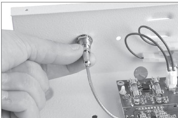
b) Inserire il cavo del modulo GSM nell'apposito connettore dell'antenna avendo cura di serrare il dado come mostrato in figura. Infine, fissare al contenitore il cappuccio in ABS, a protezione dell'antenna, utilizzando le viti in dotazione.
