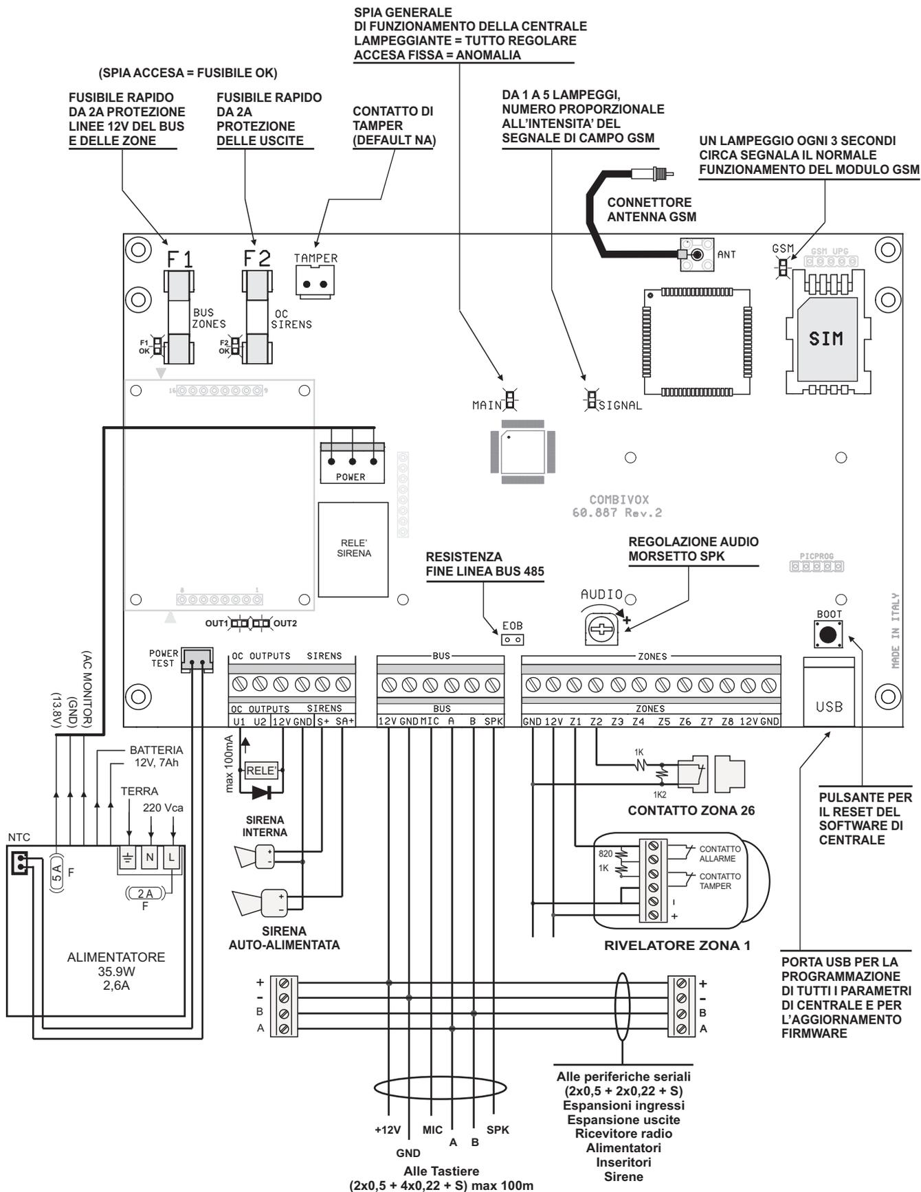
Figura 1: Schema della centrale ELISA 24 con descrizione di fusibili, spie, morsetti e pulsanti
