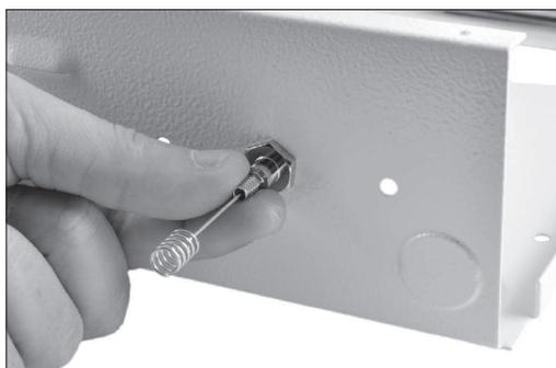
a) Inserire l'antenna nell'apposito foro e avvitare il dado in dotazione per il fissaggio dell'antenna al contenitore metallico.
