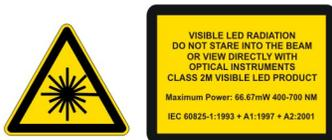
**Il proiettore è una sorgente di classe 2M di radiazioni LED visibili e invisibili. Se la luce LED viene osservata direttamente mediante determinati strumenti ottici (quali lenti di ingrandimento e microscopi) entro una distanza di 100 mm, potrebbero insorgere rischi di danni alla vista.**
