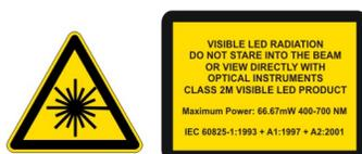
Prestare attenzione all'etichetta sul proiettore che indica possibili rischi per la vista nel caso in cui la luce delle radiazioni LED visibili e invisibili venga osservata direttamente attraverso determinati strumenti ottici a distanza ravvicinata. La Figura 1-1 Posizione dell'etichetta di attenzione del LED, a pagina 1-2 indica la posizione dell'etichetta.
