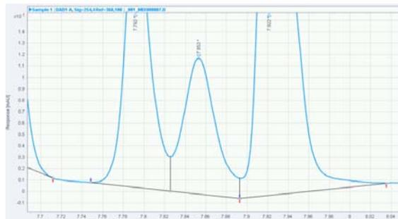
**Figura 45** Spostamento di un punto della linea di base
