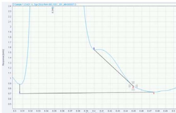
**Figura 39** Definizione del punto in cui termina la nuova linea di base nidificata
