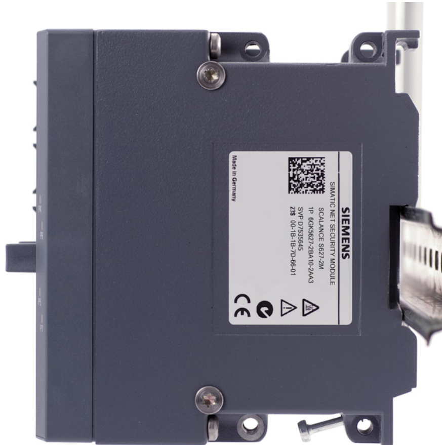
Figura 5-1 SCALANCE S Montaggio su una guida ad U DIN (35 mm)
