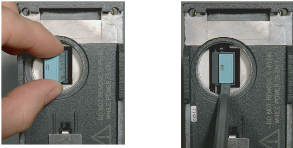
Figura 4-2 Inserire il C-PLUG nel dispositivo e togliere il C-PLUG dal dispositivo con l'aiuto di un cacciavite
