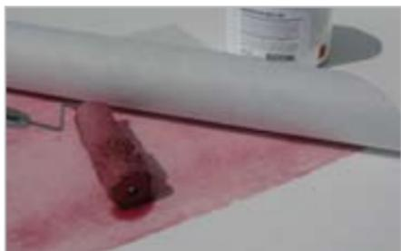
Il manto MAPEPLAN Af va incollato, totalmente o per strisce, con MAPEPLAN ADS 100, adesivo monocomponente a base poliuretanica, su diversi supporti come calcestruzzo, legno, vecchie membrane bituminose, pannelli isolanti in EPS o PUR/PIR. L'adesivo va applicato sul supporto con un rullo o con una spatola in gomma.
