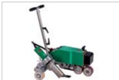
Quando si utilizza una saldatrice automatica, come ad esempio Leister Varimat (o similare approvata), con l'ugello standard, assicurarsi che la saldatrice automatica sia correttamente regolata per la saldatura del MAPEPLAN PVC-P (allineamento e temperatura) e che l'ugello standard sia pulito e con il corretto flusso d'aria. MAPEPLAN ha un'ampia "finestra di saldatura"; le temperature e le velocità di impostazione di base per la saldatura automatica del MAPEPLAN sono le seguenti:
