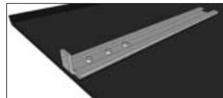
INSERIMENTO STAFFE A "L" NELLE SLITTE E ALLINEAMENTO
